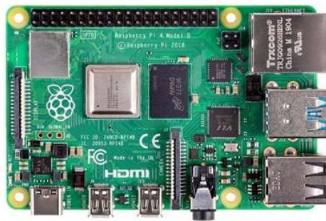
Figure 1. Photographie de la carte mère du Raspberry 4. Les ports GPIO se trouvent dans la partie supérieure gauche.
