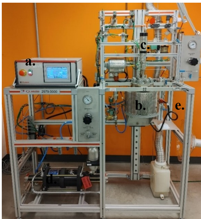
Figure 3. Réacteur d'oxydation par voie humide. A) contrôleur ; B) cuve de réaction et chauffage ; C) sonde de température et agitateur ; D) air comprimé ; E) valve de prélèvement
